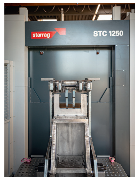
2 Die großen geschweißten Ständerbaugruppen stellen höchste Anforderungen an die Starrag STC 1250 © Starrag
